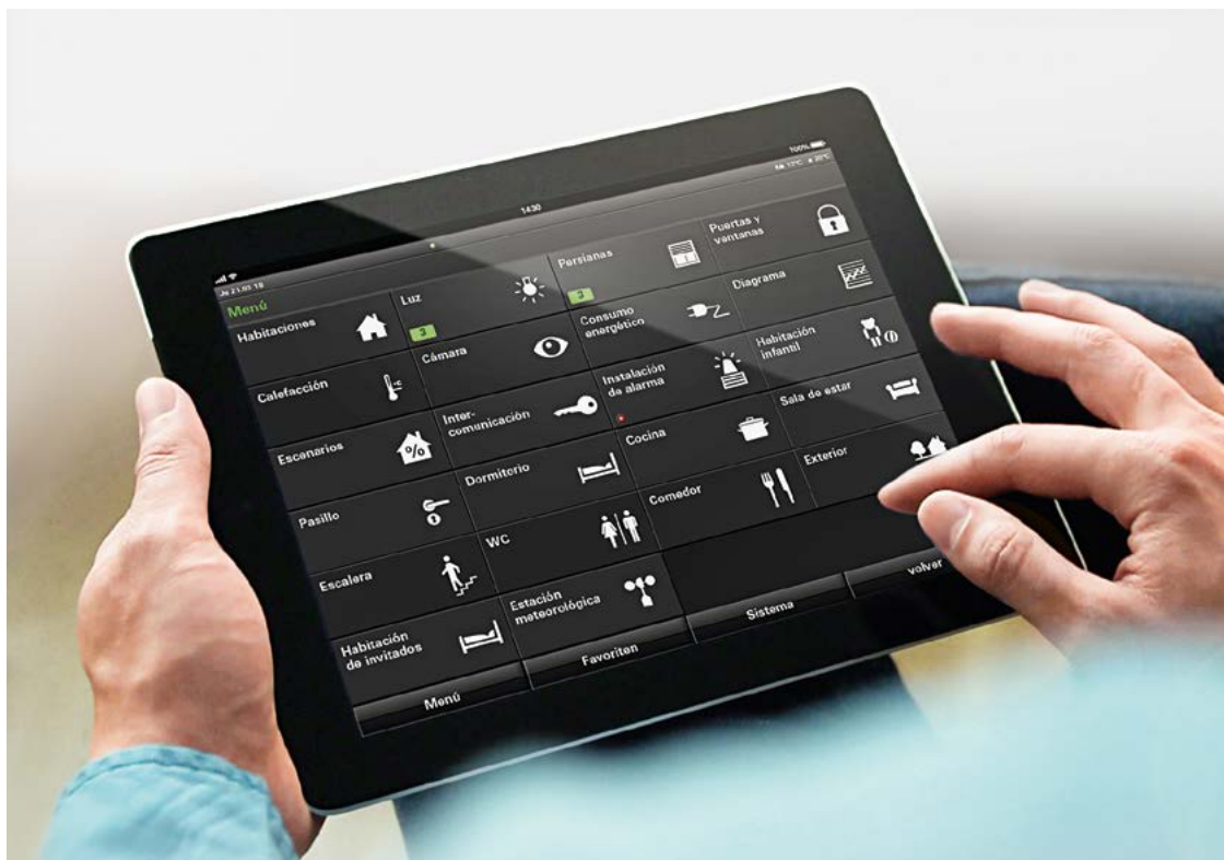
Fig. arriba: Gira HomeServer enlaza y controla los elementos de Smart Home. Se puede manejar de forma intuitiva mediante, por ejemplo, el Gira G1, que cuelga de la pared en una ubicación central de la casa. Fig. abajo: Mediante la aplicación Gira HomeServer, las funciones de Smart Home también se pueden manejar con una tablet.
