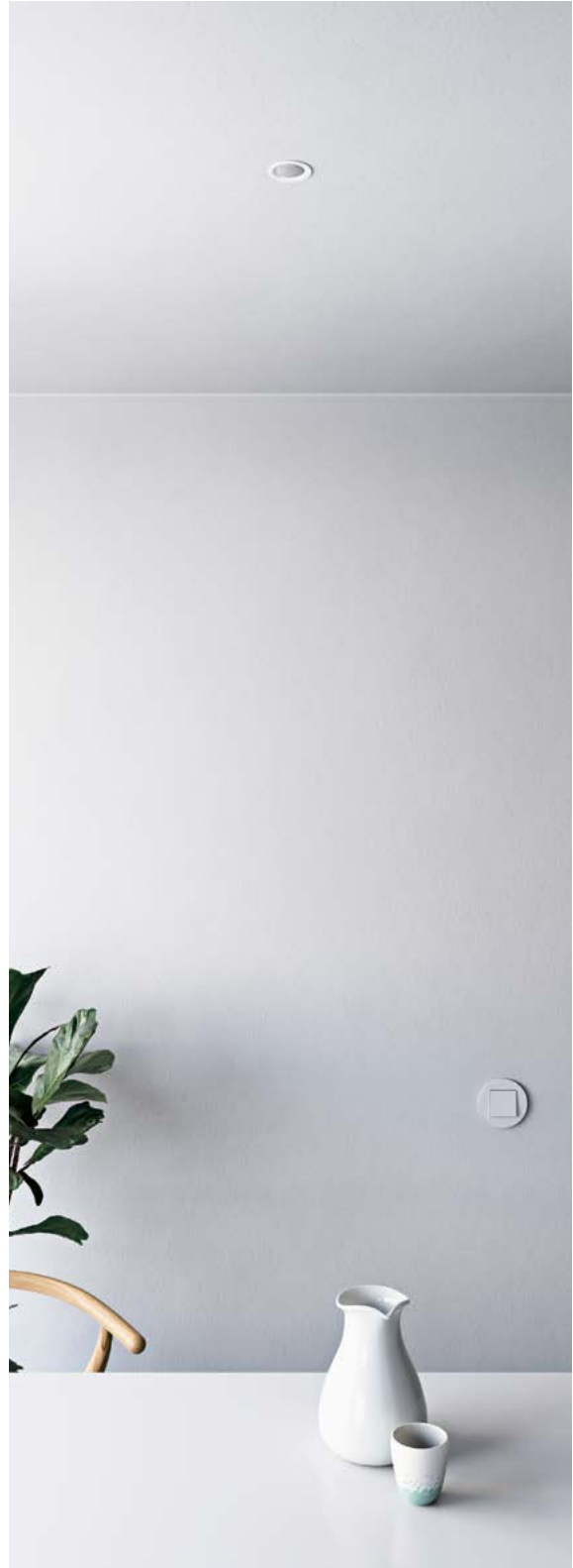
上图和下图：床旁边的紧急开关带来舒适感觉。如果发现房屋内可疑的声音或动作，可以快速操作开关。然后，为了起到威慑作用，百叶窗拉起，所有的中央照明均会亮起。
