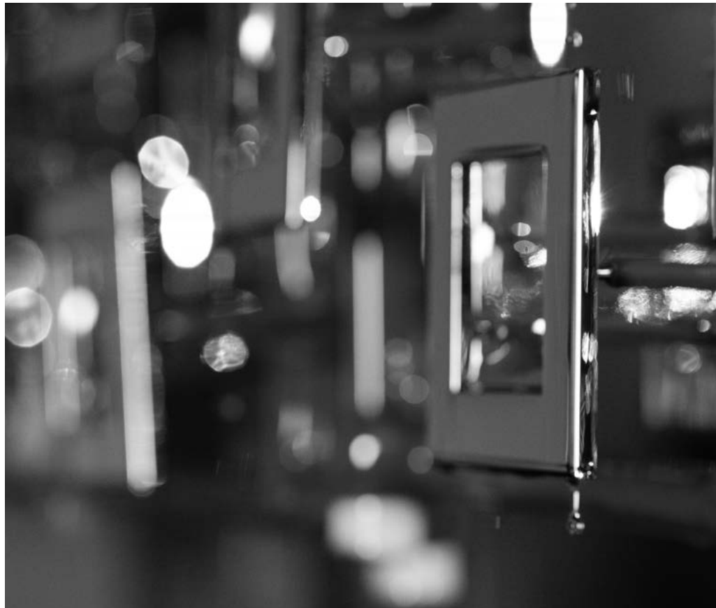
Beim Galvanisieren schlagen sich die Metallionen auf der elektrisch geladenen Oberfläche als Schicht nieder.
