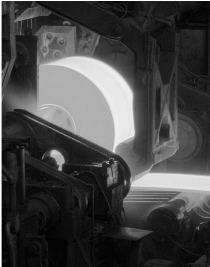
Noch glühend wird das Edeldstahlband auf Maß gewalzt.
