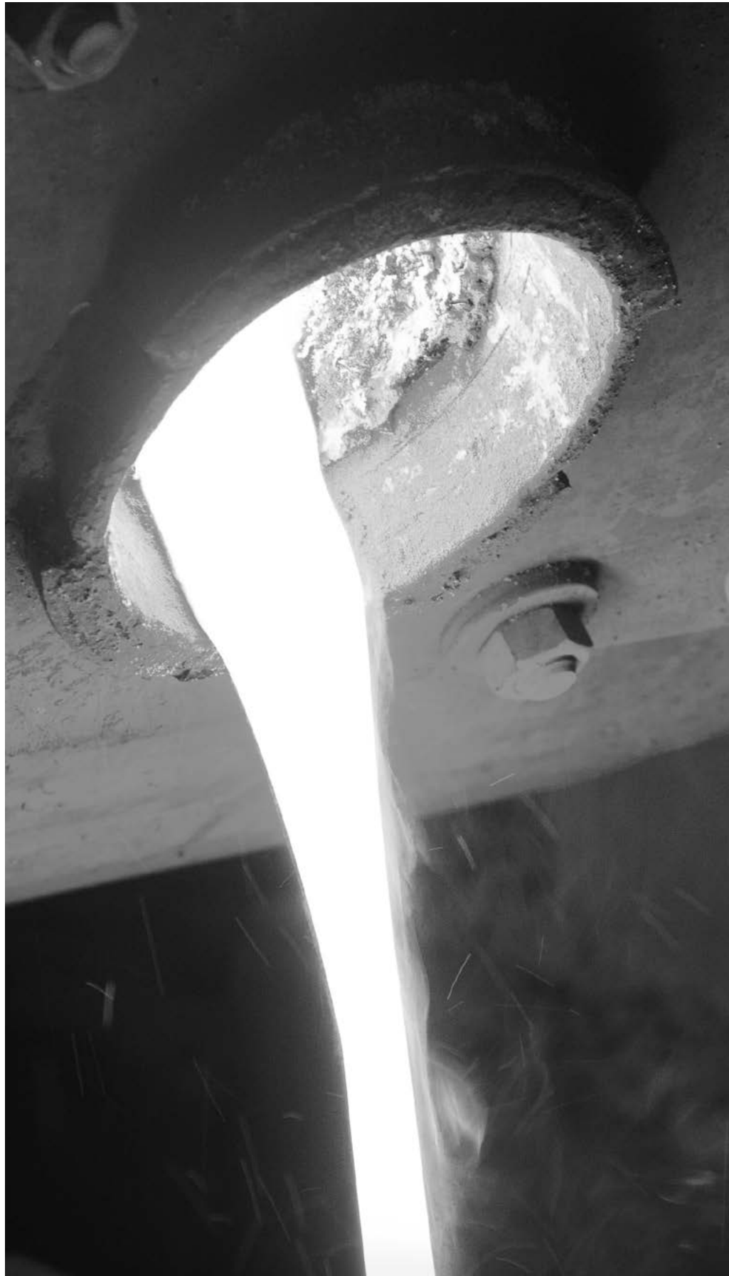
Mit einer Temperatur von über 1000°C strömt die Glasschmelze aus dem Ofen.
