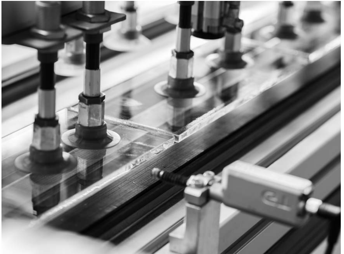
Das Brechen der Glasplatten auf Format ist Handarbeit, das Schleifen der Kanten erfolgt maschinell.
