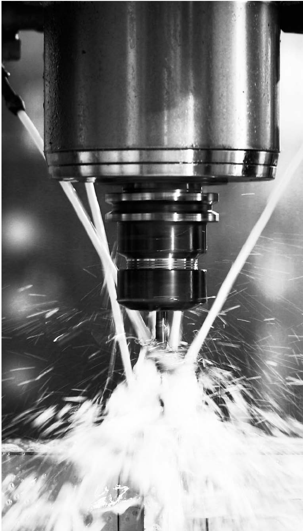
Computergesteuerte Maschinen ermöglichen die hoch präzise Bearbeitung der Esprit Rahmen aus Aluminium.
