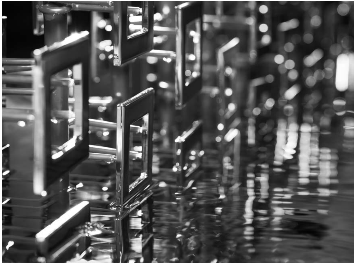
Die polierten Bauteile durchlaufen verschiedene Tauchbäder.
