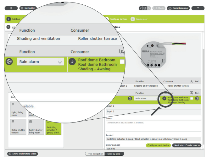
Tilordne flere forbrukere til funksjonen "Regnalarm"
