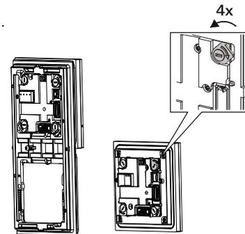
Zusammenbau in umgekehrter Reihenfolge.
