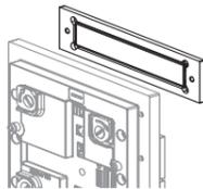
4. Установить новую кнопку вызова с передней стороны и закрутить винты (момент затяжки: 0,3 Нм).
