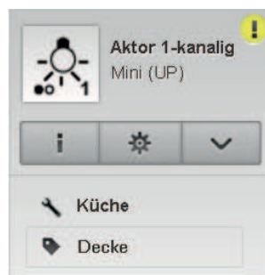
Bild 8: Gerät im Projekt entspricht nicht dem Gerät in der Installation
