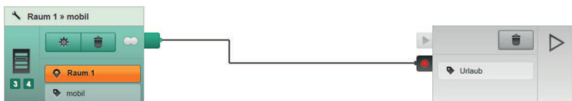
Bild 37: Sensorkanal mit Simulationsbausteins für die Aufzeichnung einer Simulation
