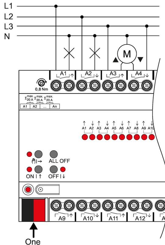
Bild 3: Geräteanschluss (Anschlussbeispiel)
