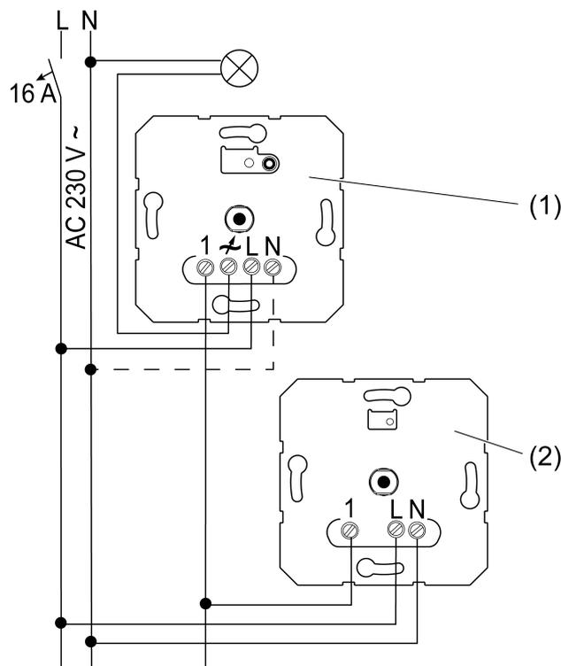
Imagen 3: Ejemplo de conexión con regulador de intensidad de luz giratorio
