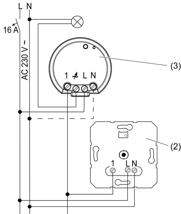
Imagen 4: Ejemplo de conexión con regulador de intensidad de luz Mini
