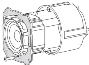
L'anello portante del modulo altoparlante è rivestito da una pellicola che disaccoppia acusticamente il modulo dall'apertura anteriore che emette il suono.
