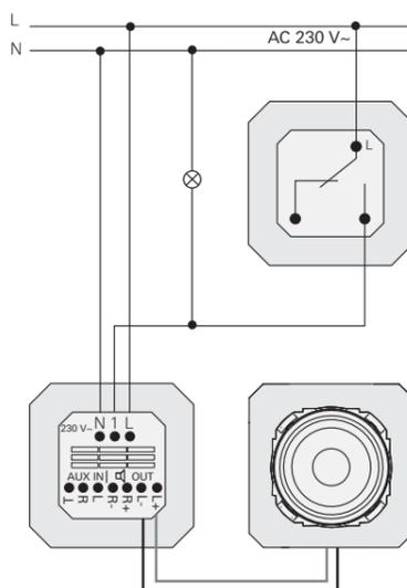
Se nell'ambiente non è disponibile una fase costantemente sotto tensione, l'allacciamento alla radio da incasso può essere eseguito in alternativa tramite la fase comandata. In questo caso la radio da incasso può tuttavia funzionare solo quando l'illuminazione è accesa.
