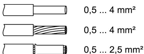
рисунок 5: Поперечные сечения проводов, на которые могут устанавливаться зажимы
