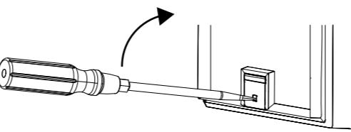
2. Inserire il modulo sensore di temperatura, ruotarlo verso l'interno e bloccarlo in posizione.
