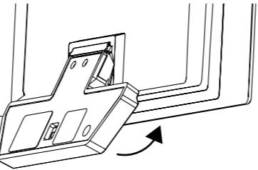
3. A questo punto è sufficiente posizionare il Gira G1 sulla piastra di montaggio e spingerlo verso il basso fino a farlo innestare in modo percepibile.
