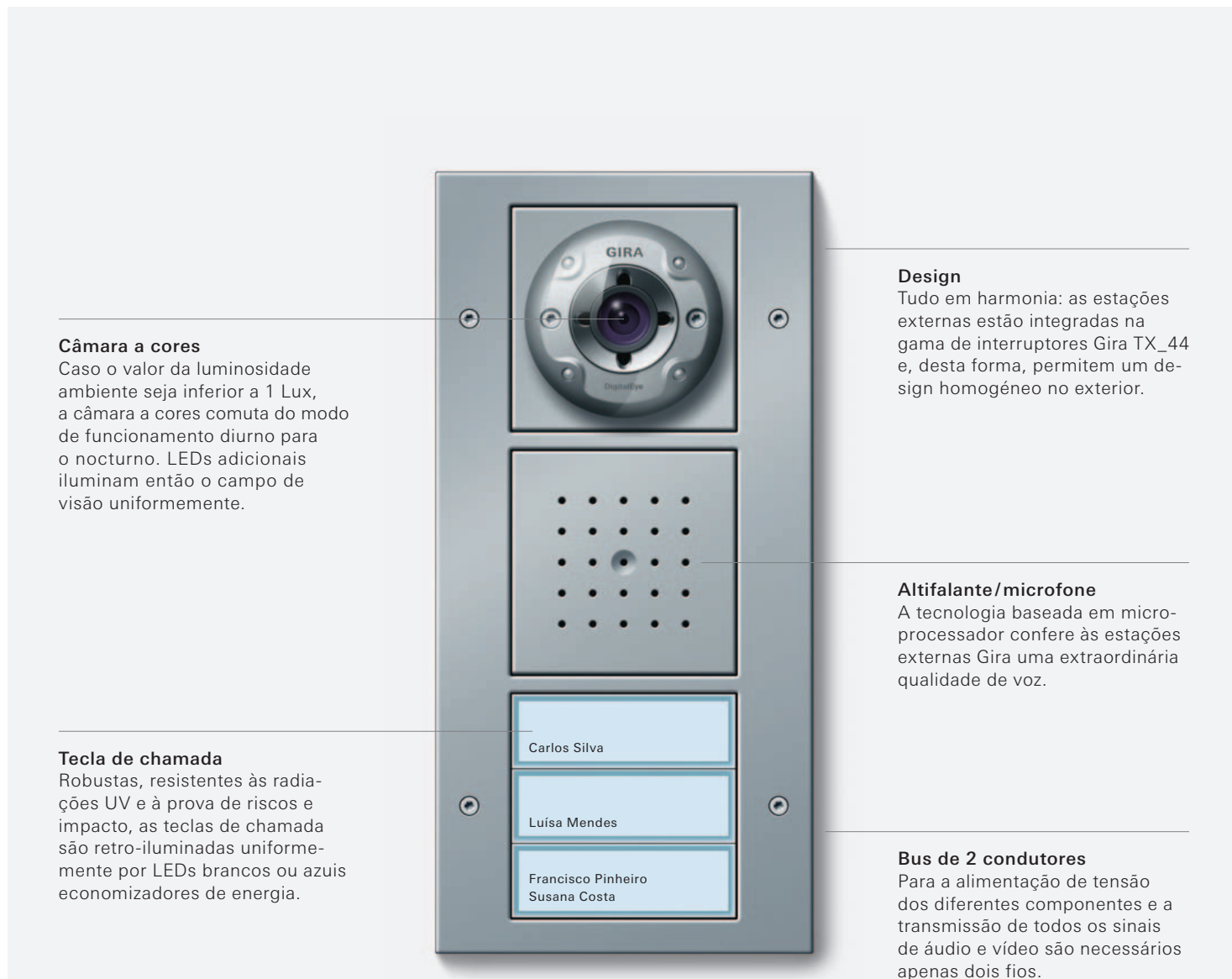
Figura: Estação externa Gira de 3 vias com câmara a cores, cor alumínio
