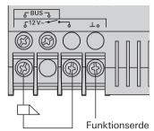
L'uscita "12 V AC" serve ad alimentare elettricamente e ad attivare l'apriporta (8 - 12 V, max. 1,1 A).
