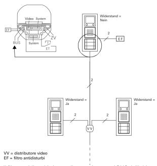
Il filtro antidisturbi viene collegato ai morsetti BUS dell'ultimo citofono interno o del citofono interno più distante in parallelo al bus bifilare.
