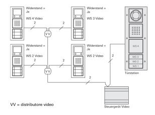
Regola n. 2:Nella linea ad anello attivare la resistenza terminale dell'ultimo citofono interno
