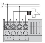
Un apriporta che, a causa dei suoi valori elettrici (ad esempio impedenza molto bassa o 24 V), non può essere collegato ai morsetti "12V AC", può essere collegato al contatto non a potenziale zero con una tensione di alimentazione esterna (230 V AC, max. 2 A).
