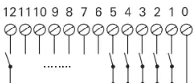
2. Anslut ringknapparna. Max ledningslängd är 2 m.
