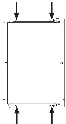
2. Fastgør monteringsrammen med de medfølgende skruer på væggen.
