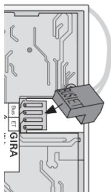
2. Faites glisser le connecteur sur les contacts de la carte à circuits imprimés d'appareil à la face arrière de la station d'appartement pour montage apparent.
