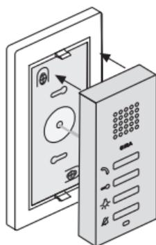
3. Fermez maintenant la station d'appartement en plaçant la partie supérieure de boîtier sur la plaque de montage et en la verrouillant.
