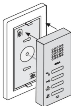
3. Conecte ahora la estación intercomunicadora doméstica, colocando la parte superior de la carcasa en la placa de montaje y encajándola.
