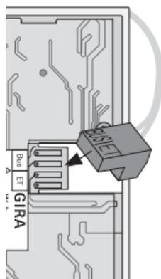
2. Deslice el conector hasta los contactos de la platina del aparato en la parte trasera de la estación intercomunicadora doméstica para montaje de superficie.
