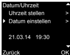
Mit  $\nabla$   $\triangle$  „Datum/Uhrzeit auswählen und mit **OK** aktivieren. Danach zwischen „Uhrzeit stellen“ und „Datum einstellen“ auswählen. Das aktuell eingestellte Datum und die Uhrzeit werden im unteren Bereich angezeigt.
