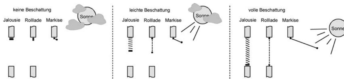
Bild 20: Prinzip eines Sonnenschutzes (Beispiele)
