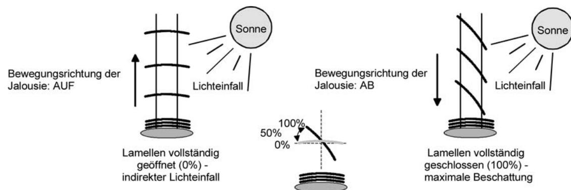
Bild 14: Typ 2 - Lamellenjalousien mit schräger und gerader Lamellenstellung
