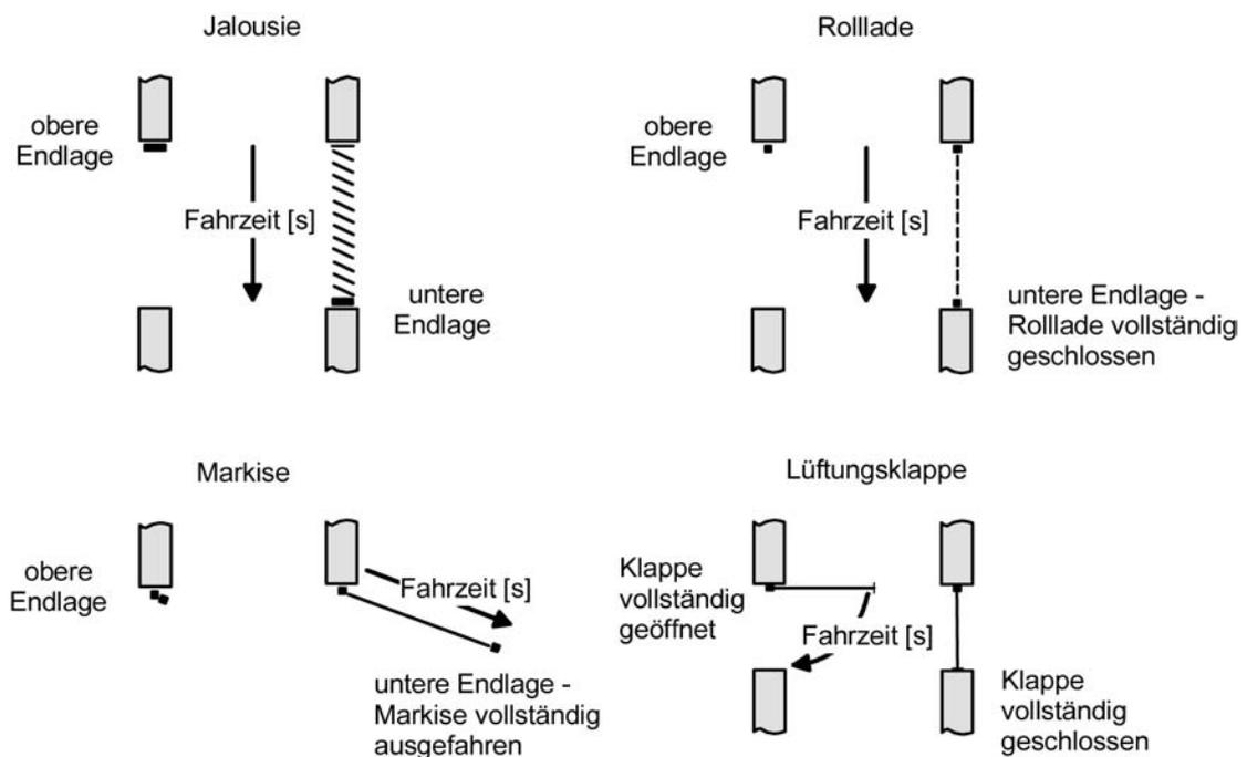
Bild 12: Ermittlung der Fahrzeit in Abhängigkeit der Antriebsart
