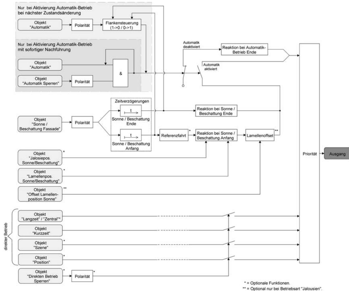
Bild 24: Funktionsschaltbild des erweiterten Sonnenschutzes
