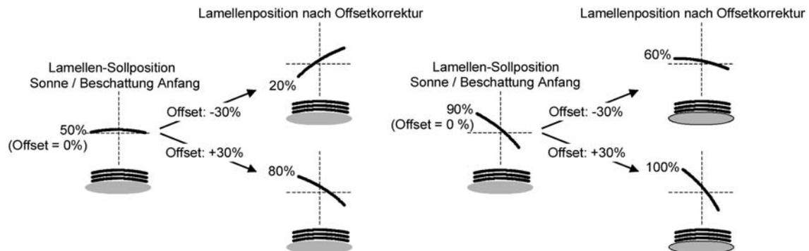
Bild 25: Funktionsweise des Lamellenoffsets als Beispiel
