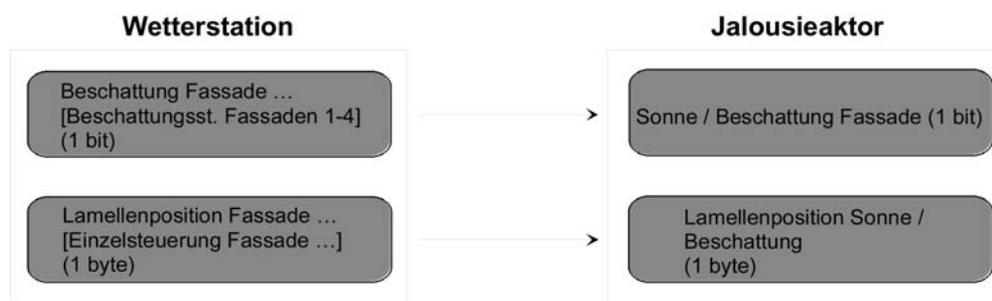
Bild 28: Projektierung der Kommunikationsobjekte für Anwendungsbeispiel III.
