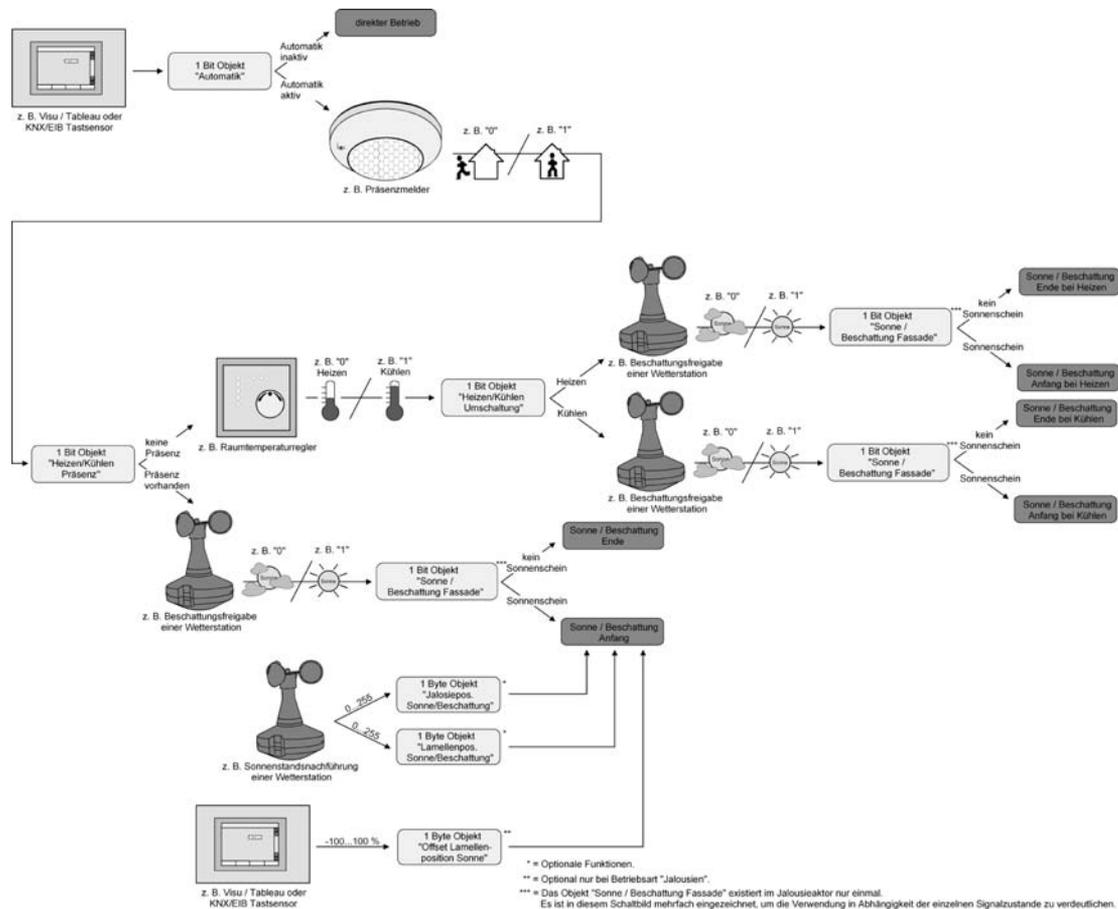
Bild 31: Prinzipschaltbild der Heizen/Kühlen-Automatik
