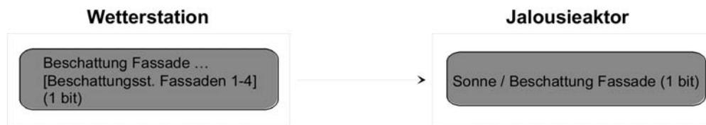
Bild 27: Projektierung der Kommunikationsobjekte für Anwendungsbeispiel II.
