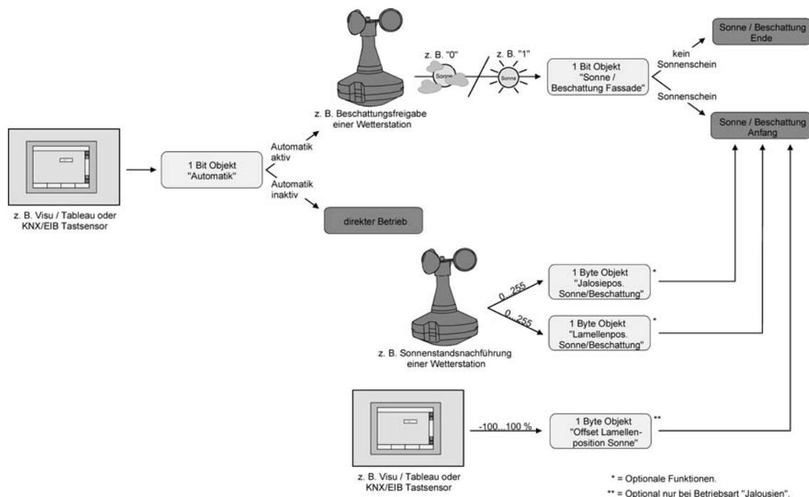
Bild 23: Prinzipschaltbild des erweiterten Sonnenschutzes
