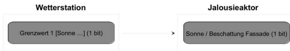
Bild 26: Projektierung der Kommunikationsobjekte für Anwendungsbeispiel I.
