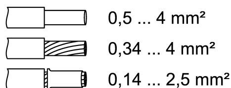
рисунок 8: Сечение провода под клемму
