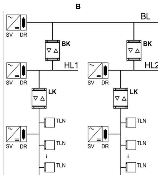
**Schéma de principe d'un système KNX/EIB**
