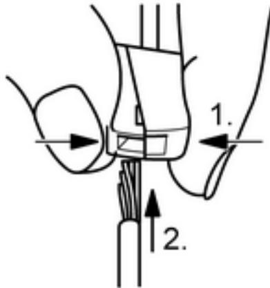
Imagen 6: Conexión del conductor de hilo fino
