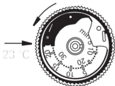
4. Για να ρυθμίσετε το μπλε δακτύλιο ρύθμισης στο κάτω όριο της θερμοκρασίας (εδώ 8 °C):
