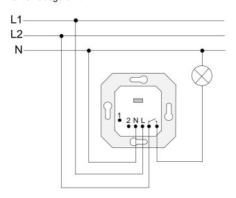
Anschluss mit mechanischer Nebenstelle Phase L mit Eingang Relais verbinden ('Drahtbrücke')
