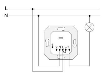
Anschluss auf 2 Phasen Der Zeitschaltuhr Einsatz ist mit potentialfreien Kontakten ausgeführt.
