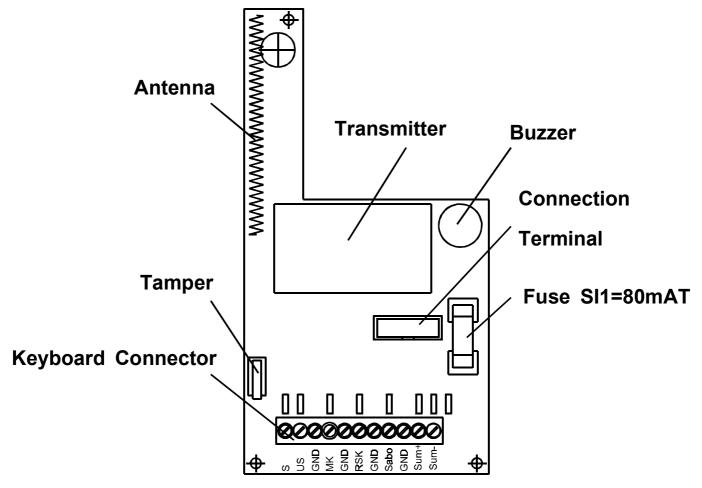
Fig. 13: Radio door Module Terminal Board
