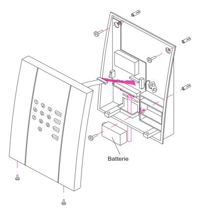
Fig. 10: Radio Door Module
