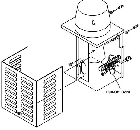
Fig. 37: External Flashing-Light Siren
