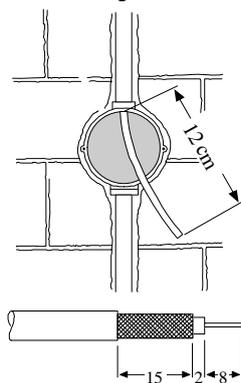
1. Las tomas de antena se pueden introducir en cajetines para empotrar con 58 mm  $\varnothing$ . Disponga un cable coaxial con una reserva de aprox. 12 cm en el cajetín para empotrar. Quite el revestimiento del extremo del cable.
