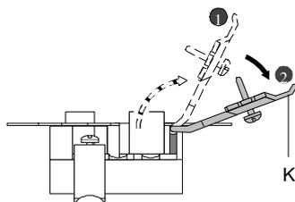
2. Abra la abrazadera con articulación K desde la posición ① hasta la posición ②. K está bloqueada en la posición ②.
